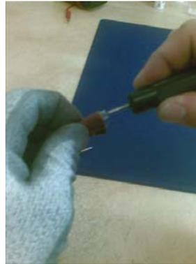
Das Endstück einführen, indem Sie es in das Gewindekernloch einschrauben; dabei das Kabel mit dem Schmirgelleinen halten.
