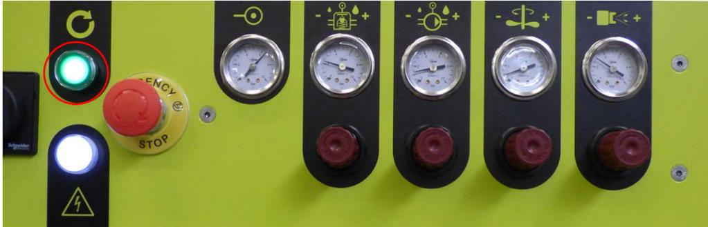
**Das erste Drücken** setzt die Druckluftversorgung der Pumpe und des Reglers (falls vorhanden) sowie die Belüftung des Schrankes in Gang.
