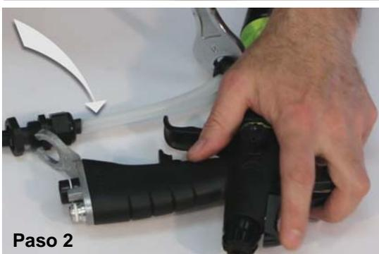
**Para volver a montarlo**, atornille la tuerca inferior del tubo de pintura, hasta el tope. Posicione la contra tuerca del prensaestopa debajo de la escuadra, y el prensaestopa superior en la huella hexagonal. Apriete la contra tuerca del prensaestopa sobre la escuadra.
