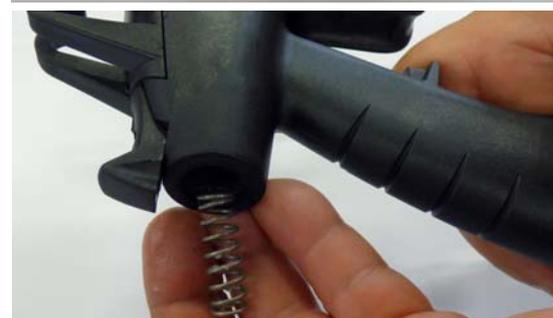
o utilice la punta de pintura para hacer salir la válvula de aire.
