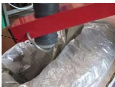
La braccio (1 pompa a polvere unicamente) può ruotare sul lato per liberare l'accesso e bloccarsi in posizione laterale.
