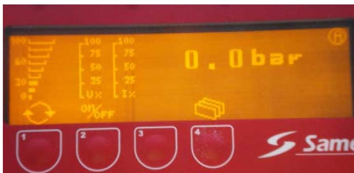
**Nota:** se il operatore preme sul pulsante “Marcia / Arresto” dello Spraymium prima di chiudere il circuito entre H e S, non ha alta tensione.
