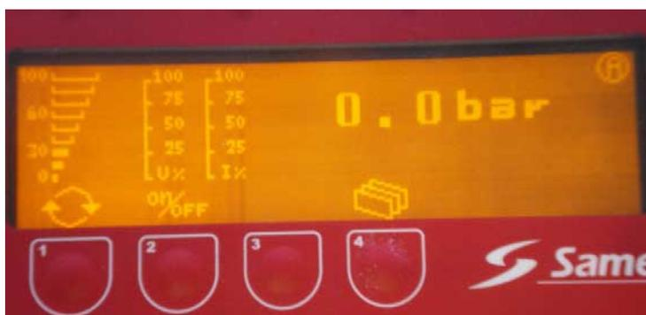
**Nota :** se il operatore preme sul pulsante "Marchia / Arresto" dello Spraymium prima di premere sul tasto 2 "ON/OFF" dello Spraybox, non ha alta tensione.
