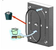
Desmontar la junta tórica. Limpiar la brida trasera con el solvente apropiado, insistir en la ranura de la junta. Es obligatorio cambiar la junta durante el montaje.
