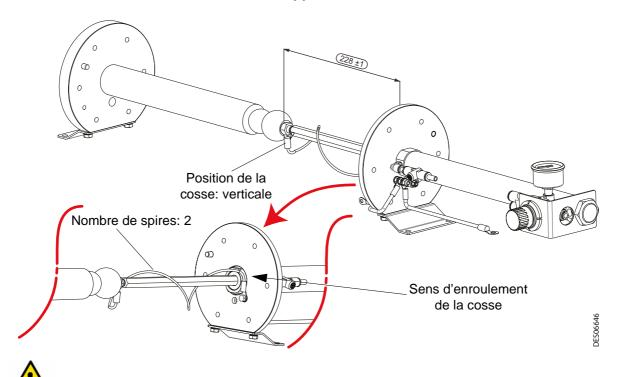
IMPORTANT: Au remontage: retirer les restes de graisse sur le câble.
